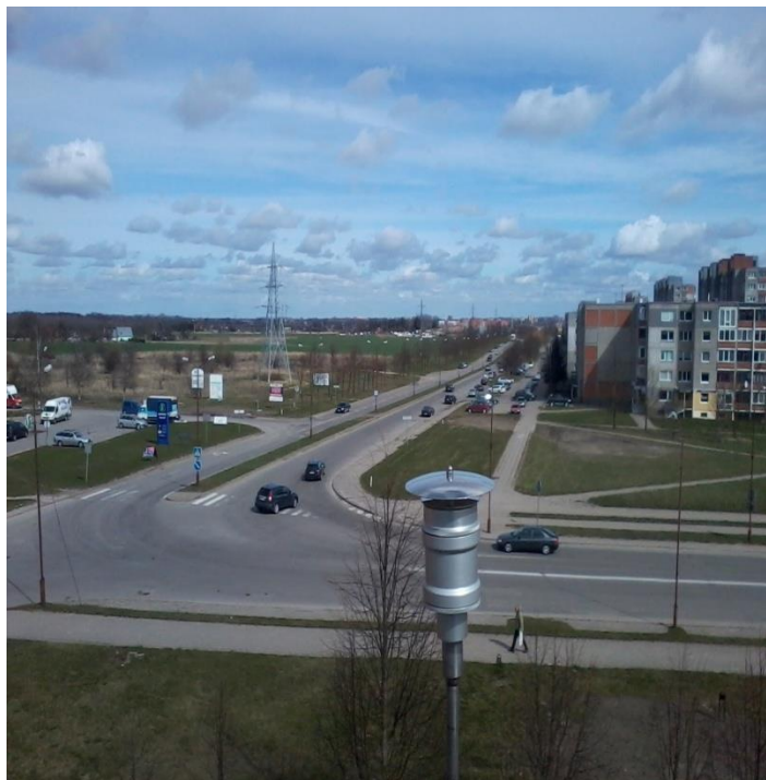
115 pav. Nuolatiniai kietųjų dalelių ( KD_{10} ) koncentracijos matavimai analizatoriumi MP101M laboratorijoje (Šiaulių m. pietinis gyvenamasis rajonas, adr.Gegužių g. 94)
