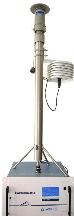
115 pav. Nuolatiniai kietųjų dalelių ( KD_{10} ) koncentracijos matavimai analizatoriumi MP101M laboratorijoje (Šiaulių m. pietinis gyvenamasis rajonas, adr.Gegužių g. 94)
