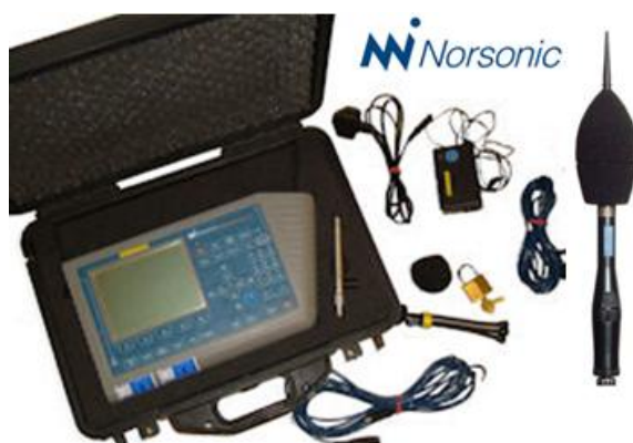
113 pav. Triukšmo lygio matavimams naudojamas skaitmeninis garso analizatorius Nor121
